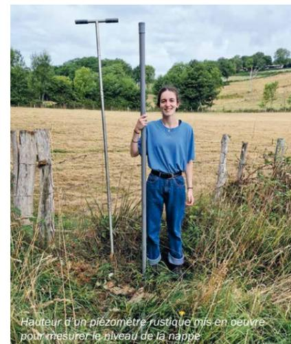
Hauteur d'un piézomètre rustique mis en œuvre pour mesurer le niveau de la nappe
