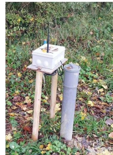
Dispositif de mesure piézométrique
