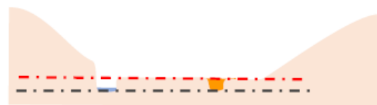
1-a : L'ouvrage est-t-il calé trop haut, y-a-t-il eu une réhausse du radier de l'ouvrage ?
