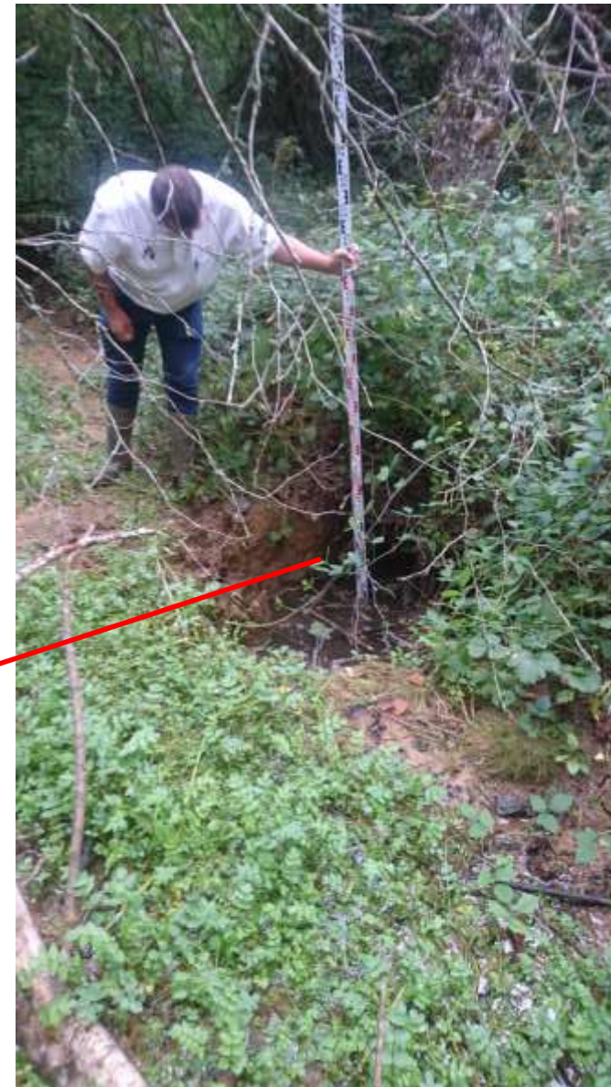
Le gouffre s'étant agrandi, il a été décidé de déplacer le cours d'eau pour éviter cette zone.
