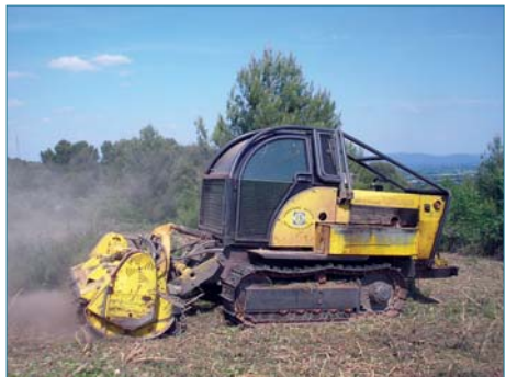
Figure 4.13. Engin de broyage en action sur végétation arbustive dense (ph. J. Baudel).
